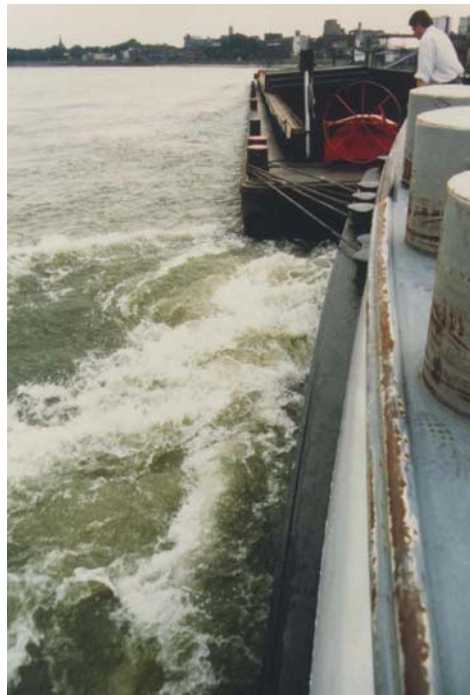
Abb. 11: Wirbelbildung an der Koppelstelle
